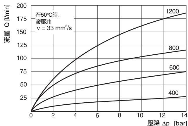
流量  $Q$  [l/min] =  $Kv \cdot \sqrt{\frac{\Delta p}{\gamma}}$
